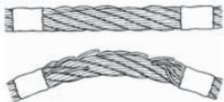
Rotture dei fili nella SEZIONE INTERNA
