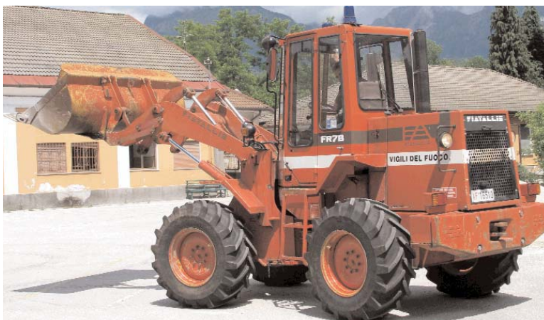
La grande capacità di spostare detriti e materiali ingombranti rende il Fiat Geotech FR 7 B un mezzo strategico per il soccorso nelle grandi calamità.
