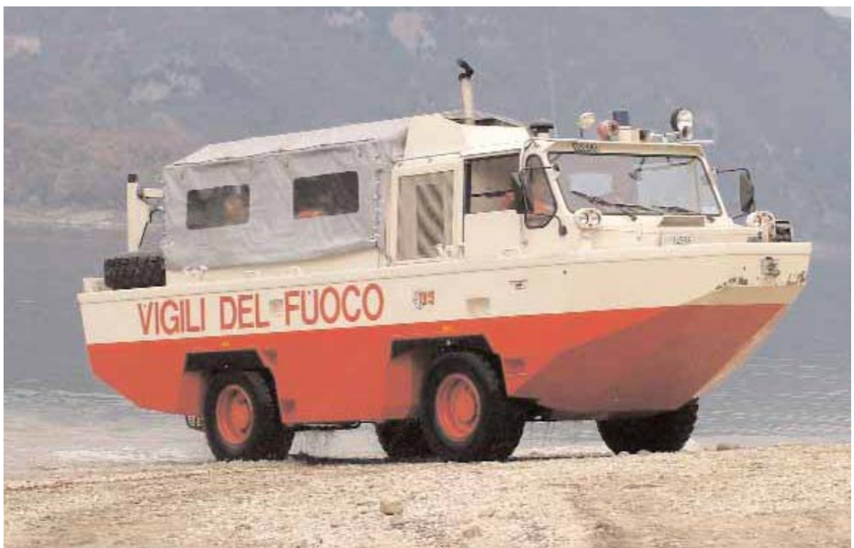
Un veicolo anfibia dei vigili del fuoco. Questo tipo di mezzo fa parte dell'allestimento delle sezioni operative in "versione alluvione".
