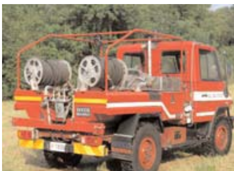
Il Combi- Fire in versione AIB (Anti Incendio Boschivo)
