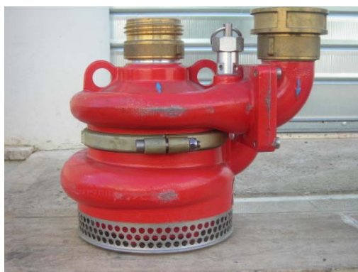
Entrata ed uscita acqua circuito primario (freccie celesti)
