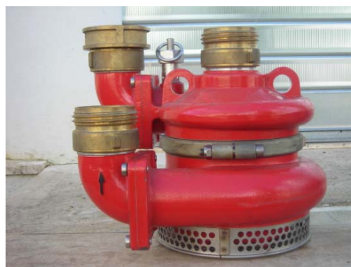
Uscita liquidi aspirati circuito secondario (freccia nera)
