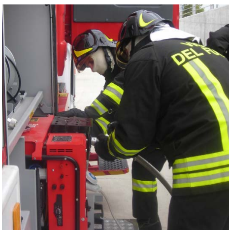
esempio di utilizzo del motogeneratore per la messa in funzione del faro portatile su treppiedi
